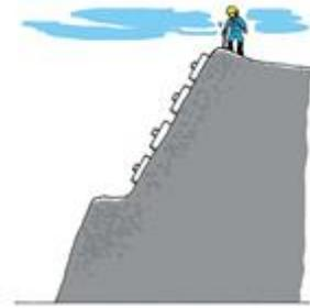
災害発生当日、現場代理人 A および作業者 B～D の 4 人で、床堀した法面へのラス張り作業と別の法面のモルタル手直し作業を行うことになっていた。作業開始とともに、B は、アンカー施工済みの法面上の地山に登り、法肩から下方 60cm の位置に打ち込んである親綱用のアンカーの点検作業をしていたところ、足を滑らせ、約 6m 下の小段上に転落し、死亡した。
